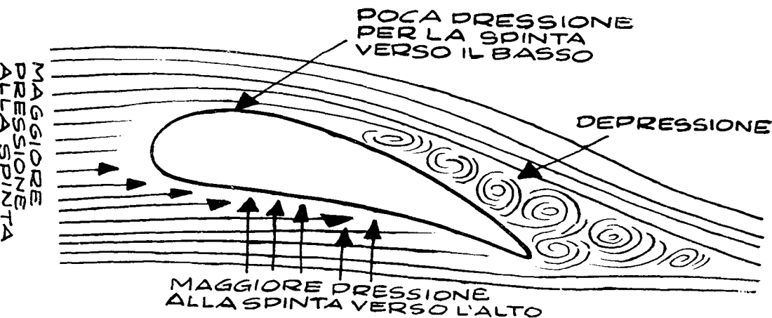
Fig. 5 QUESTA FORZA DIRETTA VERSO L'ALTO SI CHIAMA PORTANZA
